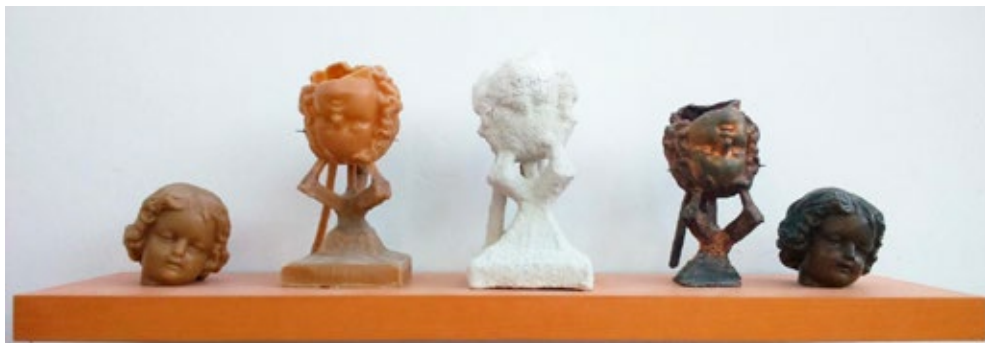
Figura 1. Secuencia de proceso de realización de escultura en bronce a través de la técnica de la cascarilla cerámica.
